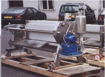
Filtere presse : 40x40-50x50-60x60 Existe en version étanche
