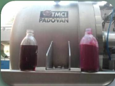
Le principe utilisé est celui de la filtration tangentielle appliquée à la rotation des disques dans le produit à filtrer, Il s'agit d'un **process autonettoyant** où les disques sont ouverts et complètement inspectables.
