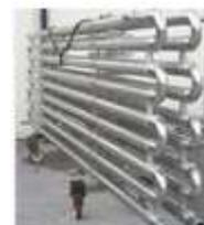
**ECHANGEUR TUBE EN TUBE**
